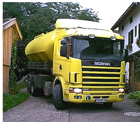
Pellets werden mit einem LKW geliefert und in den Lagerraum eingeblasen
